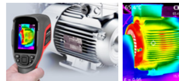
ZUSTANDSSCHÄTZUNG DER ISOLIERUNG
